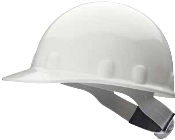
Casco de seguridad Moldeado en fibra de vidrio y resina, alta resistencia y protección a temperatura hasta 162°C (P2N) ó 260°C (P2HN). Arnés de cinta de 4 puntas con ajuste Ratchet.
